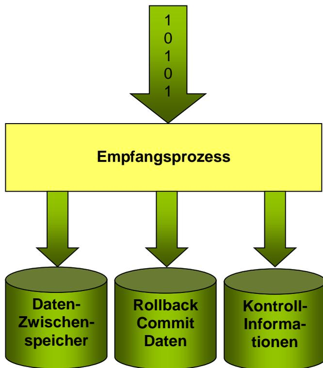
Alle gesendeten Daten werden empfangen und über entsprechende Wiederanlauf-routinen gegen Leitungsstörungen abgesichert
